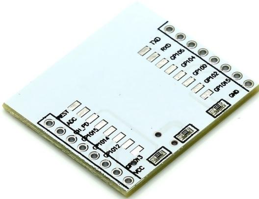
Breakout Adapter Board für ESP8266 WiFi Serial Module
