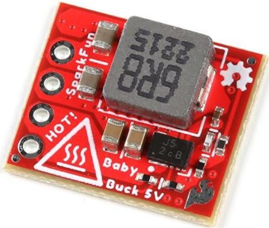
Der SparkFun 5V BabyBuck Regulator Breakout enthält den AP63357 von Diodes Inc., einen synchronen 3,5A Abwärtswandler mit einem breiten Eingangsspannungsbereich von 3,8V bis 32V. Der voll integrierte 74mΩ High-Side-Leistungs-MOSFET/40mΩ Low-Side-Leistungs-MOSFET sorgt für eine hocheffiziente Abwärts-DC/DC-Wandlung.
