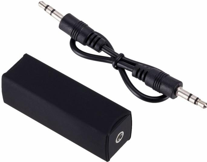
Dieser Audio Entstörfilter beseitigt Brummgeräusche in Klinken-Audioverbindungen die durch unterschiedliche Massepotentiale verursacht werden. Der Filter wird einfach in die Klinkenverbindung gesteckt und benötigt keine Stromversorgung.
