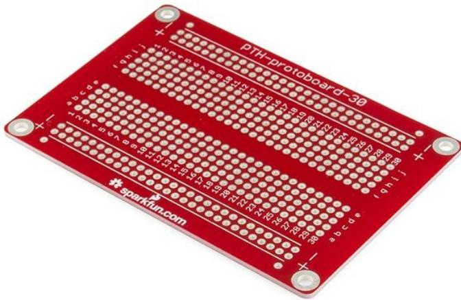
Dies ist das SparkFun Solderable Breadboard. Eine blanke Platine, die genau die gleiche Größe hat wie unser reguläres Breadboard mit den gleichen Anschlüssen an Pins und Stromschienen. Dieses Board ist besonders nützlich, um einen Prototyp oder ein Experiment, das Sie gerade auf einem lötfreien Breadboard erstellt haben, zu erhalten, indem Sie alle Teile an Ort und Stelle einlöten.
