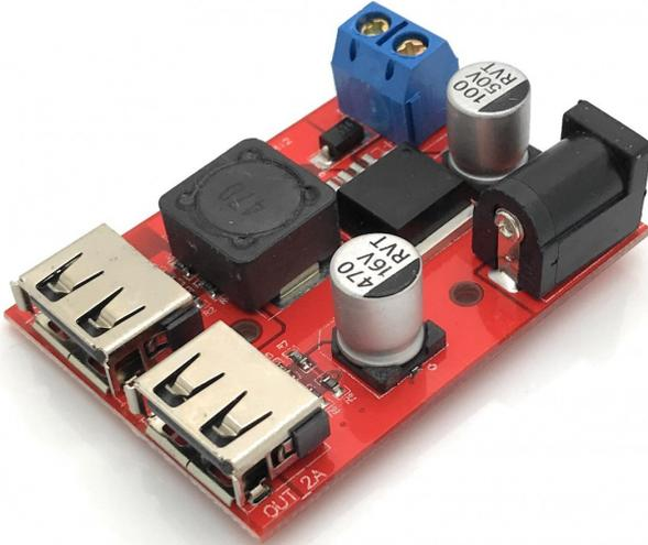
Dieses Modul reguliert die Spannung von 6V-40V auf 5V/3A. Diese Spannung kann als USB Ladegerät oder zur Spannungsversorgung von z.Bsp. Raspberry Pi, Arduino.... genutzt werden.
