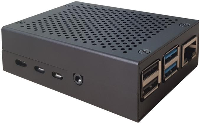
Widerstandsfähiges Industrie-Gehäuse für Raspberry Pi.
