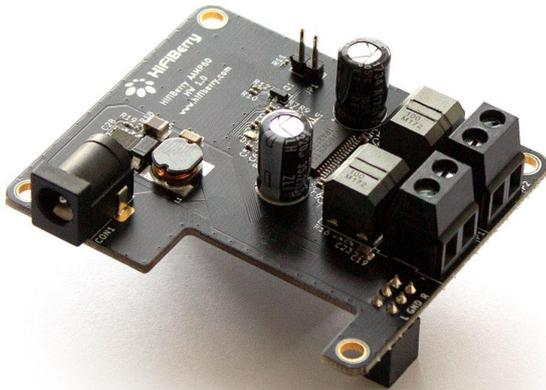
Der AAMP ist eine analoge Verstärkererweiterung für einige HiFiBerry-Boards. Er wird an Ihre HiFiBerry-DAC-Platine angeschlossen und erweitert diese um einen 60-W-Analogverstärker. Über eine 12-20V-Stromversorgung versorgt er nicht nur den Verstärker, sondern auch den DAC und den Raspberry Pi.
