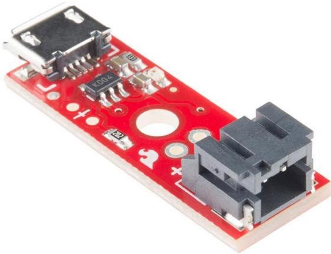
Wenn Sie LiPo-Akkus laden müssen, wird dieses einfache Ladegerät genau das tun, und zwar schnell! Der SparkFun LiPo Charger Basic ist auf alle Funktionen verzichtet und macht nur eine Sache gut - 3,7V LiPo-Zellen mit einer Rate von 500mA laden. Es ist für das Laden von einzelligen Li-Ion oder Li-Polymer Akkus ausgelegt. Überprüfen Sie das Datenblatt unten, um zu sehen, ob es mit Ihrem Akku funktionieren wird.
