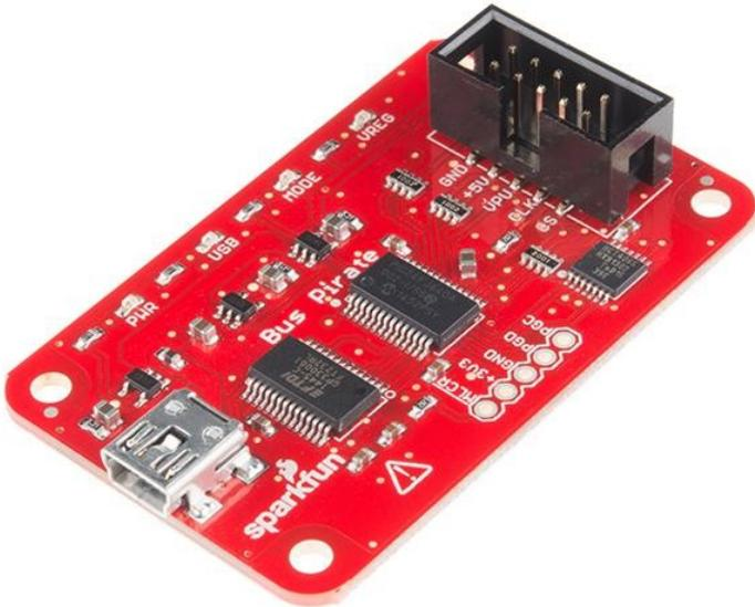
Der Bus Pirate v3.6a, erstellt von [Ian Lesnet](#), ist ein Tool zur Fehlersuche, das zwischen einem PC und einem beliebigen Embedded-Gerät über 1-Draht-, 2-Draht-, 3-Draht-, UART-, I2C-, SPI- und HD44780-LCD-Protokolle kommuniziert - und das bei Spannungen von 0-5,5VDC. Dieses Produkt eliminiert eine Menge frühen Prototyping-Aufwand bei der Arbeit mit neuen oder unbekanntenen Chips.
