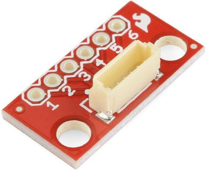
Dies ist eine universellere GPS-Breakout-Platine, die einen vertikalen SMD-Stecker (EM406) verwendet, der perfekt für den GP-735T GPS-Empfänger ist, den wir verkaufen. Es verfügt über 2 Montagelöcher und Durchgangslochanschlüsse für Drähte oder Header. Dies ist ein niedrigeres Profil Breakout und sollte sich als viel einfacher zu verwenden, während Platz in jedem Projekt, das Sie es für benötigen zu speichern!
