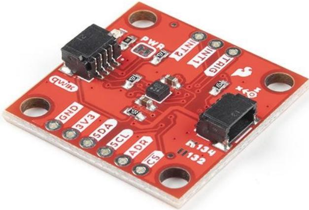
Dieses SparkFun Triple-Axis Accelerometer Breakout ist ein einfaches Qwiic Breakout für den digitalen Beschleunigungssensor KX134 von Kionix. Der KX134 ist ein Drei-Achsen-Beschleunigungssensor mit niedrigem Stromverbrauch und 16-Bit-Auflösung, der 8g/16g/32g/64g (vom Benutzer wählbar) messen kann und eine Ausgangsdatenrate von bis zu 10kHz hat, was ihn ideal für High-G-Messungen sowie Hochgeschwindigkeitsanwendungen wie z.B. Vibrationsmessungen macht.
