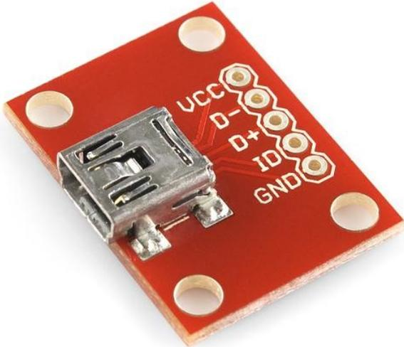
Diese neue Version hat nun alle 5 Pins auf dem Stecker herausgebrochen. Wir haben keine Ahnung, welches USB-Gerät Sie anschließen, aber wenn Sie einen miniUSB/USB Mini-B-Anschluss zu Ihrem Breadboard hinzufügen müssen - hier ist es. Auch gut für eine unregelte, nicht begrenzte 5V-Versorgung bis zu 100mA.
