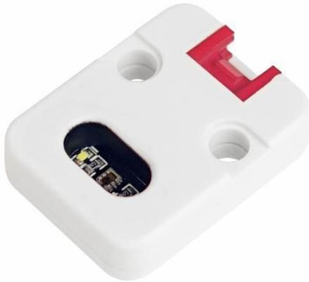
**Color Sensor Unit** ist eine in den **TCS3472** Chipsatz integrierte Farberkennungseinheit. Wie der Name schon sagt, ist die **Color Unit** in der Lage, Farbwerte zu erkennen und RGB-Daten als Antwort zurückzugeben.
