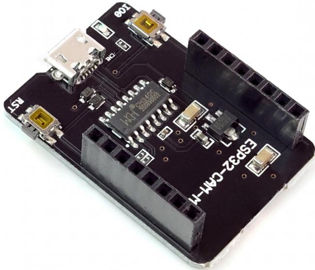
Das HK-ESP32-CAM-MB ist eine Dockingstation für das Kompaktkameramodul HK-ESP32-CAM. Die HK-ESP32-CAM-MB ist mit einer USB-zu-Seriell-Schnittstelle ausgestattet, was das Programmieren benutzerfreundlicher gestaltet. Zur einfachen Bedienung befinden sich 2 physische Taster auf dem Board, eine Reset- und eine Download-Taste.
