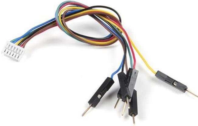
Dies ist ein praktisches Kabel, um einen sechspoligen verriegelbaren GHR-06V-Stecker mit Breadboard-freundlichen Steckerstiften zu verbinden. Das Kabel ist mit einem verriegelbaren GHR-06V-JST-Stecker im Raster von 1,25 mm ausgestattet, wie er bei einigen Sensoren, Funkgeräten und anderen kleinen Geräten zu finden ist.
