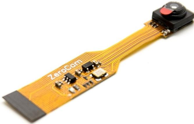
Diese Raspberry Pi-Kamera verwendet den gleichen OV5647-Chip wie die Standard Raspberry Pi-Kamera (Version 1) und liefert ein kristallklares Bild mit 5 MP Auflösung oder eine 1080p HD-Videoaufnahme mit 30 Bildern pro Sekunde.
