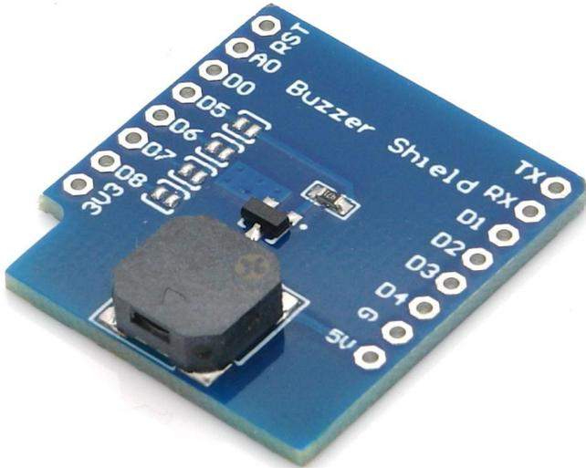
Mit diesem Shield lässt sich der D1 Mini um einen Buzzer / akustischen Signalgeber erweitern.
