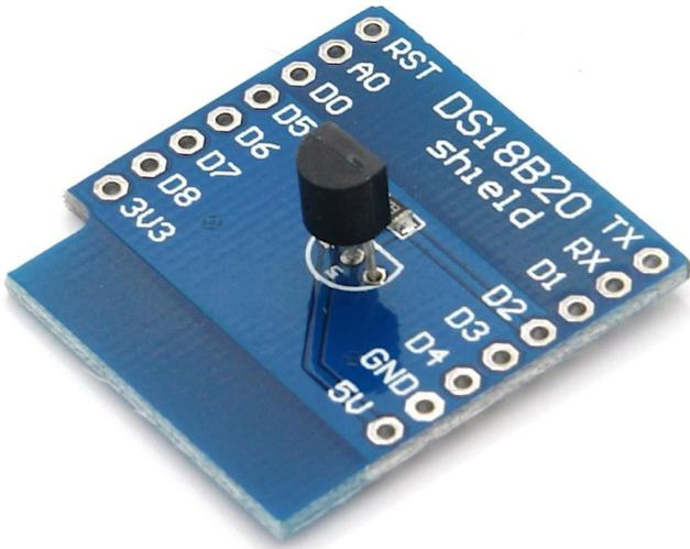
Mit diesem Shield mit DS18B20 Sensor lässt sich der D1 Mini um eine Messmöglichkeit für Temperatur erweitern.
