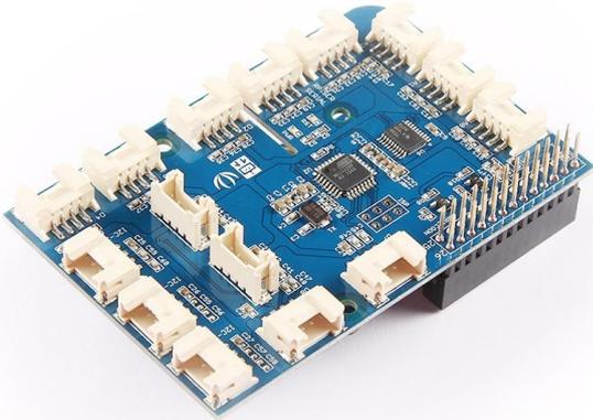
GrovePi+ ist eine Zusatzplatine mit 15 Grove 4-Pin-Schnittstellen, die Grove-Sensoren an den Raspberry Pi bringt. Es ist die neueste Version, die perfekt mit Raspberry Pi Modell B/B+/A+/2/3/4 kompatibel ist.
