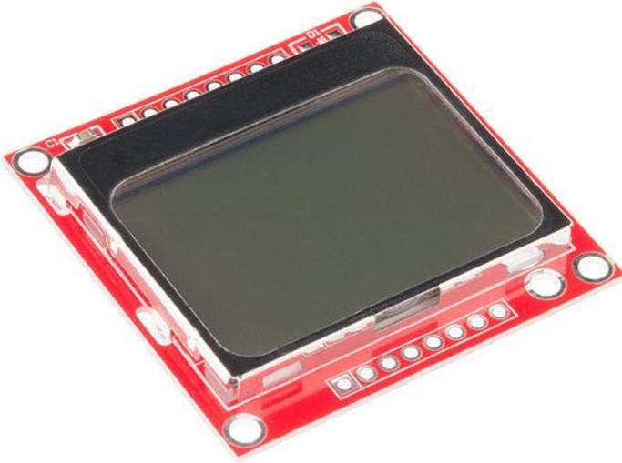
Das Nokia 5110 ist ein einfacher grafischer LCD-Bildschirm für viele Anwendungen. Es wurde ursprünglich als Handy-Bildschirm konzipiert. Dieser ist auf einer einfach zu lötenden Platine montiert.
