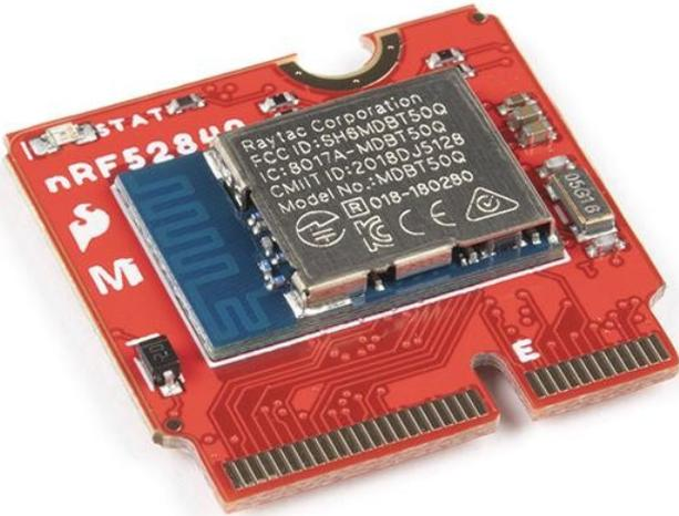
Der SparkFun MicroMod nRF52840 Prozessor mit dem nRF52840 SoC von Nordic Semiconductor bietet eine leistungsstarke Kombination aus ARM Cortex-M4-CPU und 2,4-GHz-Bluetooth-Transceiver im MicroMod-Formfaktor mit dem M.2-MicroMod-Anschluss, damit Sie ein kompatibles MicroMod Carrier Board mit einer beliebigen Anzahl von Peripheriegeräten anschließen können.
