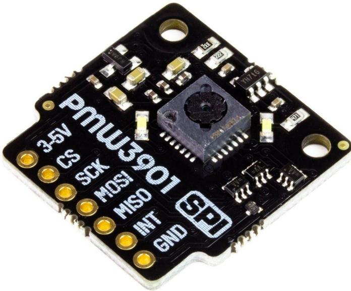
Dieser schicke optische Strömungssensor erkennt die Bewegung von Oberflächen vor ihm, von ~80mm bis unendlich! Er eignet sich hervorragend für DIY-Drohnen und ist kompatibel mit unserem neuen Breakout Garden HAT mit SPI.
