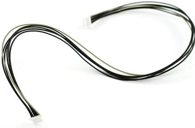
Dies ist ein 30cm langes JST SH-Kommunikationskabel, das geschnitten und nach Ihren Bedürfnissen gehackt werden kann. Ideal, wenn Sie ein UAV-Projekt haben, bei dem das GPS-Modul eine Entfernung von der Controller-Platine haben kann. Das Kabel hat zwei 6-polige JST-Stecker mit 1mm Raster. Verdrahtet Pin 1 auf Pin 1.
