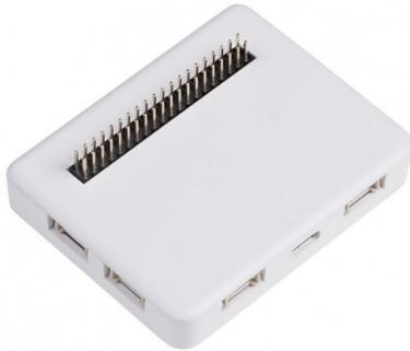
Das Wio Terminal Battery Chassis ist eine unverzichtbare Erweiterungsplatine für das Wio-Terminal Dev Board, da es eine externe Stromquelle für das Wio Terminal bietet, um dessen Tragbarkeit und Kompaktheit zu verbessern. Es verfügt über eine wiederaufladbare Lithium-Polymer-Batterie mit 650 mAH, eine LED für den Lade-/Entladestatus, 4 analoge/digitale Grove-Anschlüsse, 1 Grove-I2C-Anschluss und 1 Grove-UART-Anschluss sowie ein ABS-Gehäuse für Ästhetik und Schutz.
