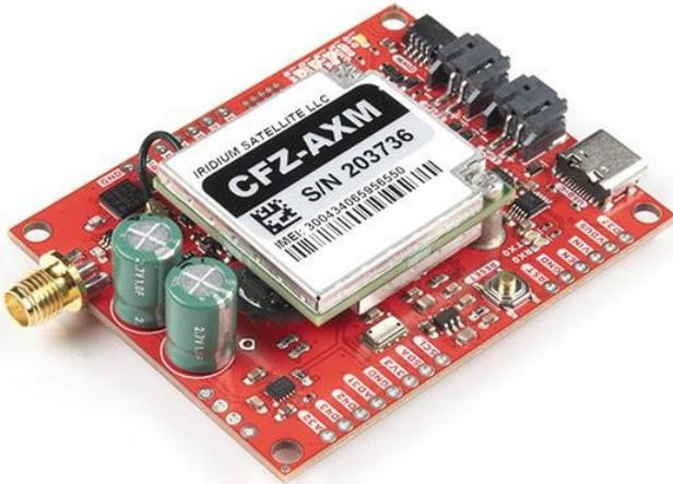
Könnte dies der Tracker sein, der sie alle übertrifft? Mit dem Artemis-Modul, dem Iridium 9603N Short Burst Data Modem, dem u-blox ZOE-M8Q GNSS-Empfänger und einem TE MS8607 PHT-Sensor ermöglicht dieser kompakte Tracker eine unglaubliche Anzahl von Dingen, die früher sehr schwierig waren.
