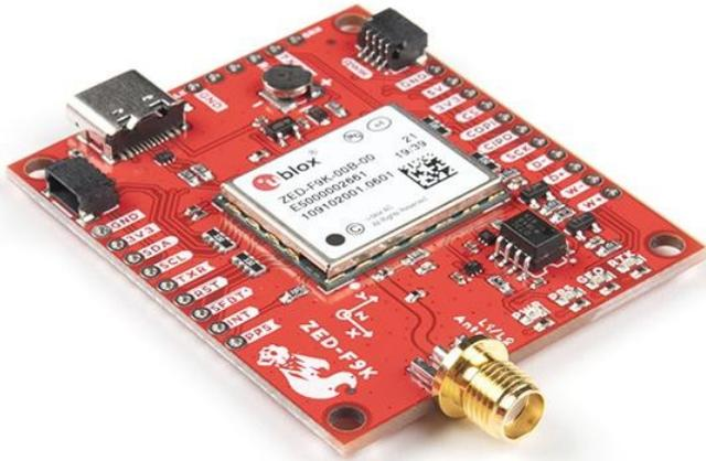
Das SparkFun ZED-F9K GNSS Breakout ist ein hochpräzises Geospatial-Board für die Sensorfusion mit ebenso beeindruckenden Konfigurationsoptionen und nutzt die Automotive Dead Reckoning (ADR)-Technologie von u-blox. Das ZED-F9K Modul liefert eine hochpräzise und kontinuierliche Position, indem es einen 3D-IMU-Sensor, Radticks, ein Fahrzeugdynamikmodell, Korrekturdaten und GNSS-Messungen fusioniert.
