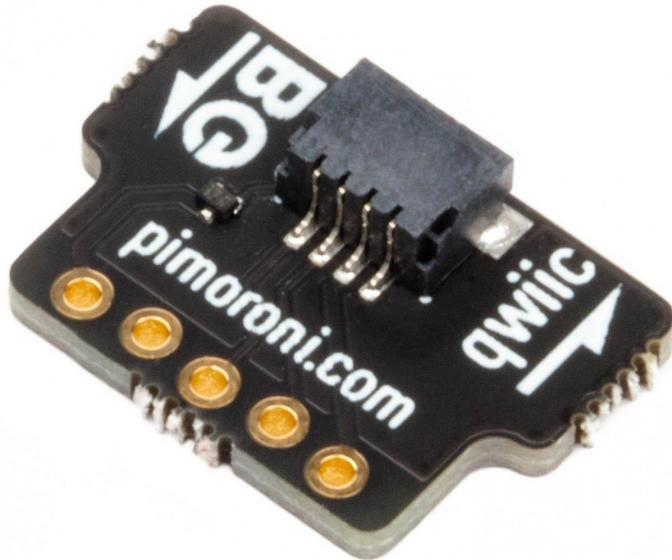
Mit diesem Adapter können Sie ein STEMMA QT / Qwiic I2C-Breakout in einen Breakout Garden-Steckplatz stecken, für ultimative Kompatibilität und einfaches Prototyping.
