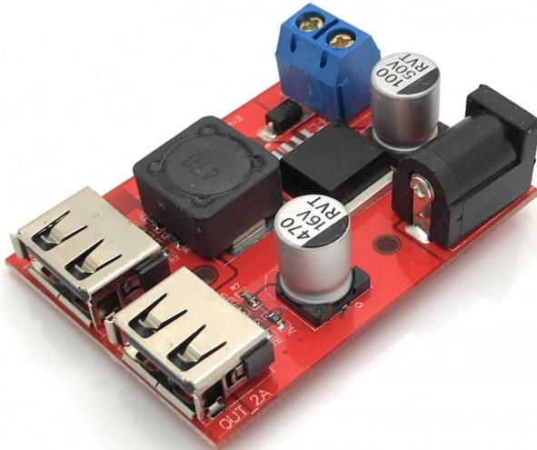
Dieses Modul reguliert die Spannung von 6V-40V auf 5V/3A. Diese Spannung kann als USB Ladegerät oder zur Spannungsversorgung von z.Bsp. Raspberry Pi, Arduino.... genutzt werden.
