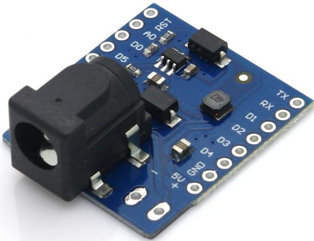
Mit diesem Shield kann der D1 Mini mit einem beliebigen Netzteil, welches im Spannungsbereich 7-24V arbeitet, betrieben werden.
