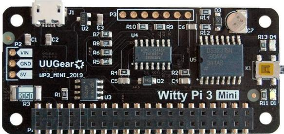
Witty Pi 3 Mini erweitert den Raspberry Pi um eine Echtzeituhr (RTC) und ein Energiemanagement und kann mit einem einfachen Skript komplexe On/Off-Sequenzen definieren.
