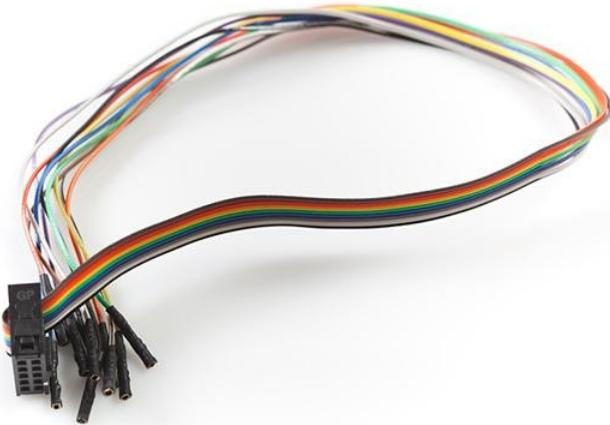
Dies ist ein Schnittstellenkabel für den Bus Pirate, das für den Anschluss an dessen 2x5 I/O-Header konzipiert ist. Der Stecker des Kabels besteht aus zwei Reihen von fünf Stiften im Abstand von 0,1"; er ist ebenso wie der Gegenstecker an Bord des Bus Pirate polarisiert, so dass Sie das Kabel nur in eine Richtung anschließen können. Die Adern des Kabels sind mit Buchsen abgeschlossen, um sie mit Prüfhaken zu verbinden.
