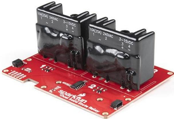
Das SparkFun Qwiic Dual Solid State Relais ist ein Power-Delivery-Board, das es dem Benutzer ermöglicht, zwei AC-Lasten von einem Low-Power-Mikrocontroller mit dem SparkFun Qwiic Connect-System zu schalten. Das Board verfügt über zwei 25A/250VAC Halbleiterrelais, die die Zero-Cross-Trigger-Methode verwenden, so dass Sie zwei Lasten an einem 60Hz AC-Trägersignal bis zu 120 Mal pro Sekunde ein- und ausschalten können!
