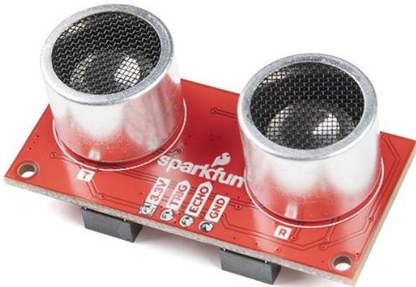
Vielleicht kennen Sie den klassischen HC-SR04 Abstandssensor. Er eignet sich hervorragend für berührungslose Abstandsmessungen von 2cm bis 400cm. Der SparkFun Qwiic-Ultraschall-Abstandssensor verbessert den Klassiker, indem er ein Paar Qwiic-Anschlüsse hinzufügt, so dass Sie jetzt über I2C kommunizieren und jedes andere Qwiic-Produkt Ihrer Wahl verketteten können.
