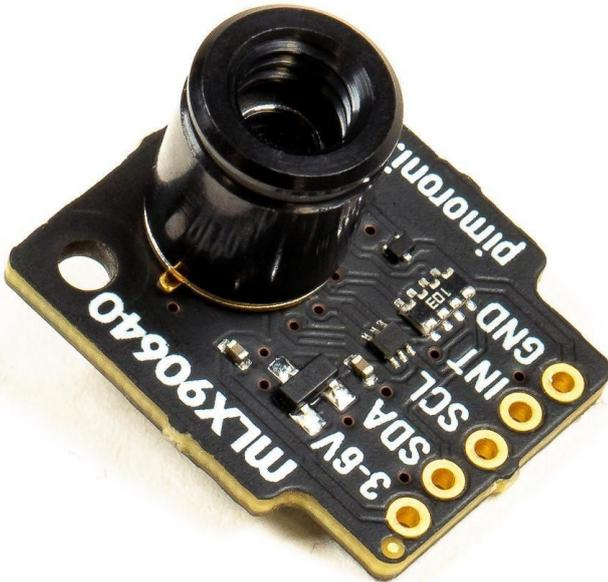
Ein ausgeklügeltes, hackbares 32x24 Pixel Wärmebildkamera-Breakout! Verwenden Sie es, um die Temperatur Ihrer CPU oder Kaffeekanne zu überwachen, oder um Ihre eigene wärmesuchende Nachtsichtkamera zu bauen. Funktioniert mit Raspberry Pi oder Arduino.
