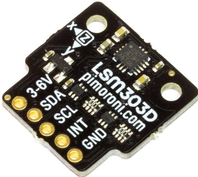
Dieser 6 Degrees of Freedom Motion Sensor Breakout kann Beschleunigung in drei Achsen - X, Y und Z - sowie drei Achsen der magnetischen Richtung erkennen. Es ist ideal für den Einbau in Roboter, Raketen und Rover oder überall dort, wo Sie Bewegungen genau messen wollen. Er ist kompatibel mit Raspberry Pi oder Arduino.
