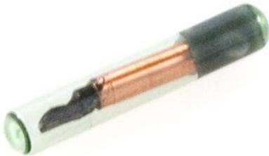
Dies ist ein gläserner, zylindrischer RFID-Tag; er ähnelt denen, die Haustieren zu Identifikationszwecken implantiert werden. Aber wirklich Leute, es ist nicht für den Einsatz in Ihrem Körper. **Bitte implantieren Sie dieses Ding nicht in sich selbst.** Jeder Tag kommt mit einem einzigartigen 32-Bit-ID-Code und ist nicht umprogrammierbar. Die Trägerfrequenz dieses Tags ist 125kHz, so dass es mit unseren ID-3LA, ID-12LA und ID-20LA RFID-Lesegeräten gut funktioniert.
