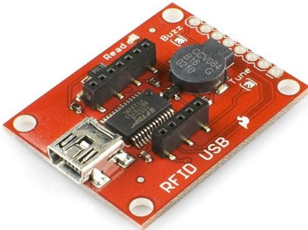
Der SparkFun RFID-USB-Reader ist eine einfach zu bedienende, USB-zu-serielle Basiseinheit für die ID-3LA-, ID-12LA- und ID-20LA-Leser. Stecken Sie einfach ein Lesegerät in die Header und schließen Sie ein Mini-USB-Kabel an. Öffnen Sie ein Terminalprogramm Ihrer Wahl mit 9600bps 8N1, scannen Sie dann Ihren 125kHz ID-Tag und die eindeutige 32-bit ID wird auf dem Bildschirm angezeigt. Das Gerät basiert auf einem FTDI-Chip und wird mit einer Lese-LED und einem Summer geliefert.
