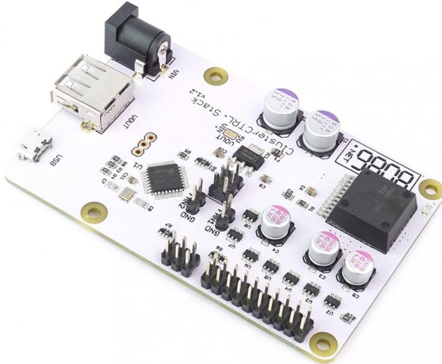
Der ClusterCTRL Stack (Controller und passive Backplane) ist eine einfache Möglichkeit, einen Stapel von 5 Raspberry Pi sowohl mit Strom zu versorgen als auch die Kühlung zu steuern.
