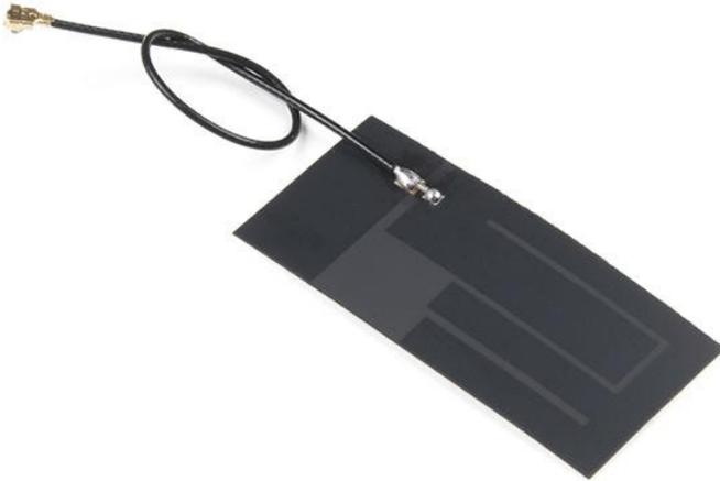
Eine breitbandige 4G LTE-Antenne mit einem Frequenzbereich von 700-2700 MHz bietet eine ausreichend große Reichweite für eine Reihe von Anwendungen, einschließlich BLE & LoRa/RF. Diese Antenne ist 53mm x 24mm groß und hat ein 100mm langes Koaxialkabel, das in einem IPEX (u.FL äquivalent) Stecker endet. Die Antenne ist mit einer 3M-Klebefläche versehen, die eine einfache Befestigung an Ihrem Projekt ermöglicht.
