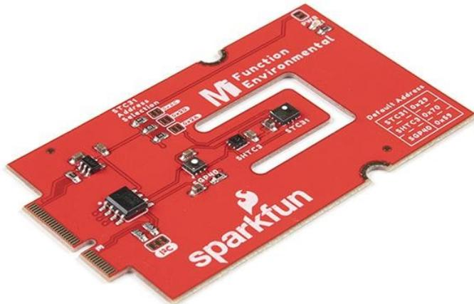
Das SparkFun MicroMod Environmental Function Board erweitert die MicroMod Processor Boards um zusätzliche Sensoroptionen. Diese Funktionsplatine enthält drei Sensoren zur Überwachung der Luftqualität (SGP40), der Luftfeuchtigkeit, der Temperatur (SHTC3) und der CO<sub>2</sub>-Konzentration (STC31) in Ihrer Innenumgebung. Um die Nutzung noch einfacher zu gestalten, erfolgt die gesamte Kommunikation über den I2C-Bus des MicroMods!
