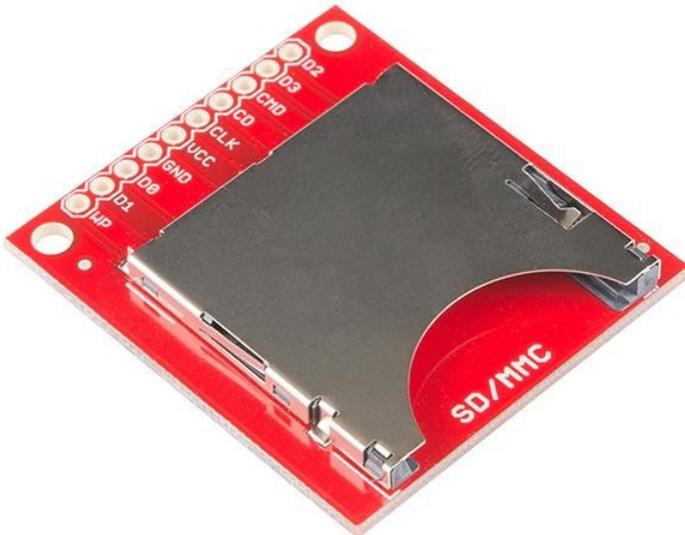
Da die Preise für SD- und MMC-Speicher fallen, ist die Zeit reif für Massenspeicher und Datenprotokollierung. Mit diesem Breakout-Board können Sie den SD/MMC-Sockel auf eine standardmäßige 10-polige 1-Zoll-Stiftleiste umstecken. Perfekt für Breadboarding und dergleichen. Das Board wird komplett montiert und wie abgebildet getestet geliefert.
