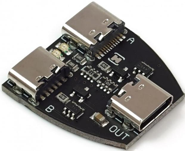
Versorgt USB-C-Geräte mit Strom aus zwei USB-C-Stromquellen.
