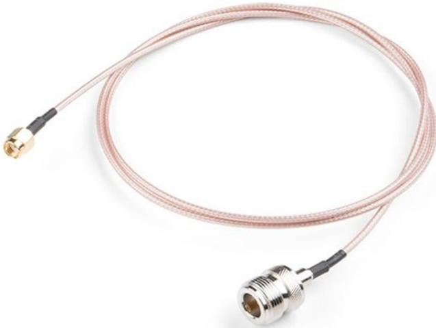
Dieses Anschlusskabel verbindet eine N-Buchse mit einem RP-SMA-Stecker. Es wird in erster Linie verwendet, um unsere größere 915MHz LoRa-Antenne mit RP-SMA-Anschlüssen zu verbinden, kann aber auch für andere Geräte bis zu 3GHz verwendet werden. Das Kabel ist vom Typ RG316. Die Länge beträgt 1m.
