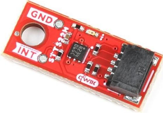
Der SparkFun STTS22H Micro Temperature Sensor ist ein Qwiic-fähiges Breakout-Board, das auf dem stromsparenden, hochgenauen digitalen Temperatursensor STTS22H von ST Microelectronics basiert und in unserem Qwiic Micro-Formfaktor untergebracht ist. Dank seiner werkseitigen Kalibrierung bietet der STTS22H eine hohe Genauigkeit über den gesamten Betriebstemperaturbereich und erreicht bis zu  $\pm 0,5^{\circ}\text{C}$ , ohne dass eine weitere Kalibrierung auf Anwendungsebene erforderlich ist.
