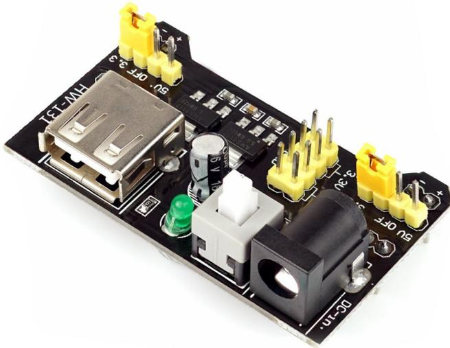
Dieses Netzteil wird einfach auf ein Breadboard gesteckt und stellt die passende Stromversorgung für Ihre Schaltung an den Seiten des Breadboards zur Verfügung. Sie können zwischen 5V und 3,3V einfach durch Umstecker von 2 Jumpfern wählen und das sogar auf beiden Seiten unterschiedlich!
