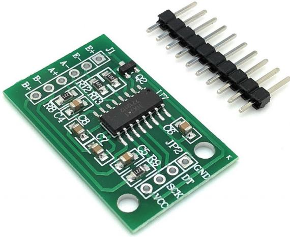
Mit diesem Breakout-Board mit HX711 Chipsatz, können Sie Wägezellen zur Gewichtsmessung einfach ablesen. Durch den Anschluss des Verstärkers an Ihren Mikrocontroller können Sie die Widerstandsänderungen der Wägezelle ablesen und mit einer Kalibrierung sehr genaue Gewichtsmessungen durchführen.
