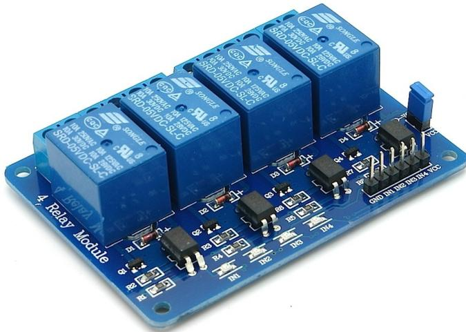
Mit diesem 4 Kanal Relais Modul können große Lasten einfach mit 5V eines Mikrocontrollers zum Beispiel Raspberry Pi, Arduino.... angesteuert / geschaltet werden. Alle Anschlüsse zum Ansteuern der Relais sind auf einer Stiftleiste zugänglich und können so einfach zum Beispiel mit Dupont Kabeln mit einem Raspberry Pi o.a. Board verbunden werden. Der Anschluss an die Relais erfolgt über Schraubklemmen.
