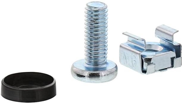
Käfigmutter-Set zum Einbau von 19" Netzwerk-Geräten in den Schrank. Die Käfigmutter werden dafür entsprechend der HE des Gerätes in die quadratischen Öffnungen der Rasterschienen geklemmt. Das Set ist bestehend aus jeweils
