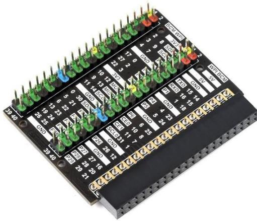
Diese auf den Raspberry Pi 400 zugeschnittene Erweiterung verdoppelt die GPIO-Pins und macht sie in einer aufrechten Form (wie bei den übrigen Pi-Modellen) verfügbar und bietet eine Farbkodierung der verschiedenen Pins.
