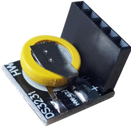
Real Time Clock / Echtzeituhr Modul mit DS3231 kompatibelem Chipsatz für Raspberry Pi mit sehr hoher Genauigkeit.
